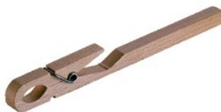
Mit dieser Holzklammer werden Reagenzgläser bis 20 mm Durchmesser zum Erhitzen über dem Bunsenbrenner festgehalten.
